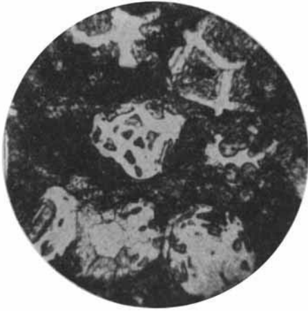
Abb. 8. Ikositetraedrische Kristalle von \text{C}_3\text{A}_2 , granatähnlich, \text{CaF}_2 dendritisch in der Grundmasse; Vergr. 46.
