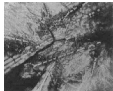
Abb. 6. Kristallskelette von \beta\text{-C}_2\text{S} , in dichter ternär-eutektischer Grundmasse; Nic. gekreuzt; Vergr. 28.
